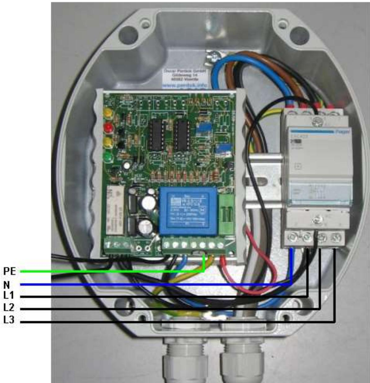
Der Anschluss muss durch eine Elektrofachkraft erfolgen. Die gültigen VDE-Vorschriften und TAB sind zu beachten. Vor in Betriebnahme sind alle Verschraubungen auf festem Sitz zu prüfen und ggf. nachzuziehen. Es wird empfohlen die Zuleitung mit 20 A abzusichern. Die Ladeeinrichtung darf nicht für Fahrzeuge mit gasende Fahrzeugantriebsbatterie verwendet werden.
